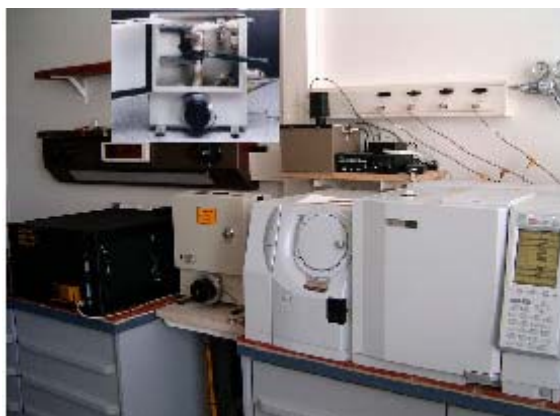
TEOM 1500 PMA/GC-MS Gázkromatográfjal és tömegspektrométerrel összekapcsolt átáramlásos mikromérleg/ mikroreaktor (Beillesztve: a mérlegrész nyitott ajtóval)
