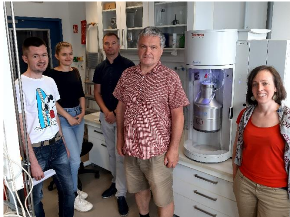
4. kép: Thermo-Fisher Scientific „Surfer” automatikus, volumetrikus adszorpciós készülék.
