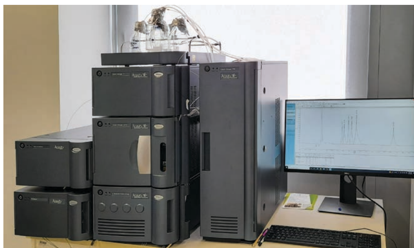
Az ACQUITY APC/UHPLC készülék: törésmutató (RI) és diódasoros UV-Vis spektrofotometriás detektorok, kvaterner gradiens pumpa, termosztálható mintaterű automata mintaadaogoló, kis méretű (4,6 × 150 mm) és nagy méretű (7,8 × 300 mm) oszlop befogadására alkalmas termosztátok. A készülék 1000 bar nyomásig működtethető.
